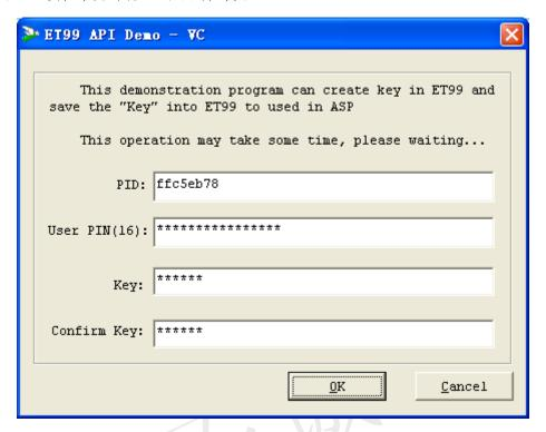
"硬件 PID": ET99 的产品标示,默认 8 个 F,通过种子码算法产生,种子即是在"PID种子"中输入的。
